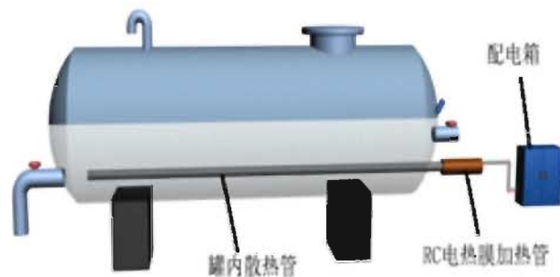
图 3 储油罐热管加热示意图
