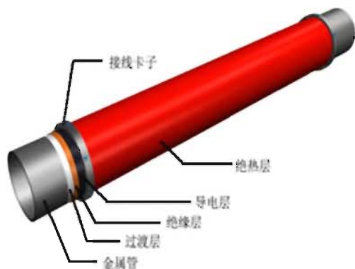
图2 RC电热膜管状结构示意图
