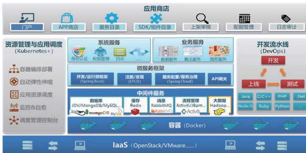
图 4 E&P.Cloud 统一技术平台技术架构
