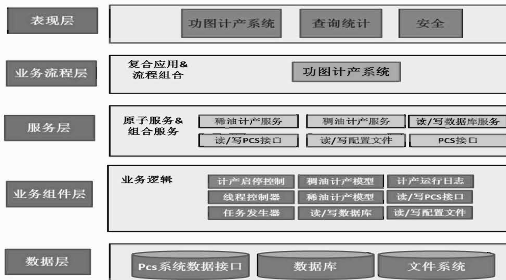
图5 功图量油系统架构
