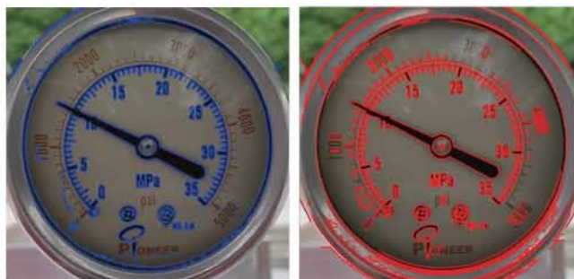
图 3 图像预处理的连通域分析对比 (左无预处理, 右有)
