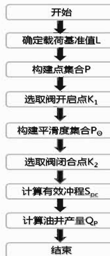
图 3 稠油功图计产原理图
