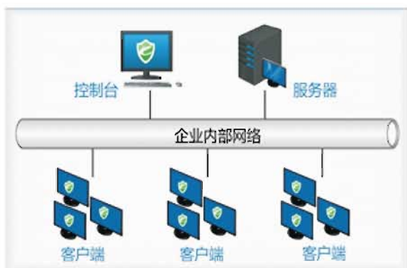
图 14 安全系统架构部署
