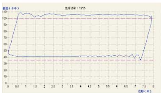
图 3 塔式抽油机井诊断界面
